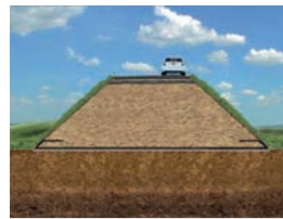
Estabilización y refuerzo de terraplenes
