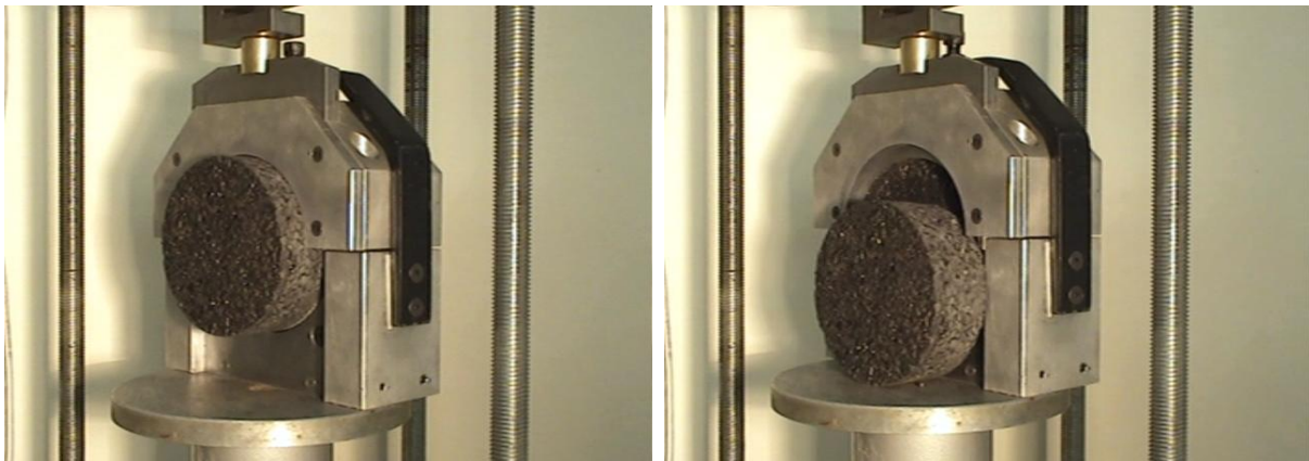
Figura 1 Ensayo de Cortante directo en muestras de 15 cm de diámetro.
