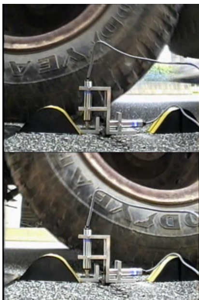
Figura 4 Posición de la rueda con relación a la grieta: (a) Cortante, (b) Flexión, (c) Cortante.
