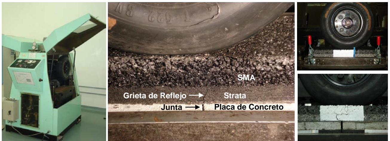
Figura 5 a) Simulador de tránsito tipo LCPC; b) Ensayo sin camada intermedia: Rápida Propagación de las grietas de reflejo.
